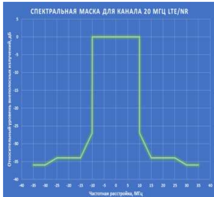
Рисунок - Маска спектра БС с функционалом DSS (выходная мощность 43 дБм, ширина несущей 20 МГц)
