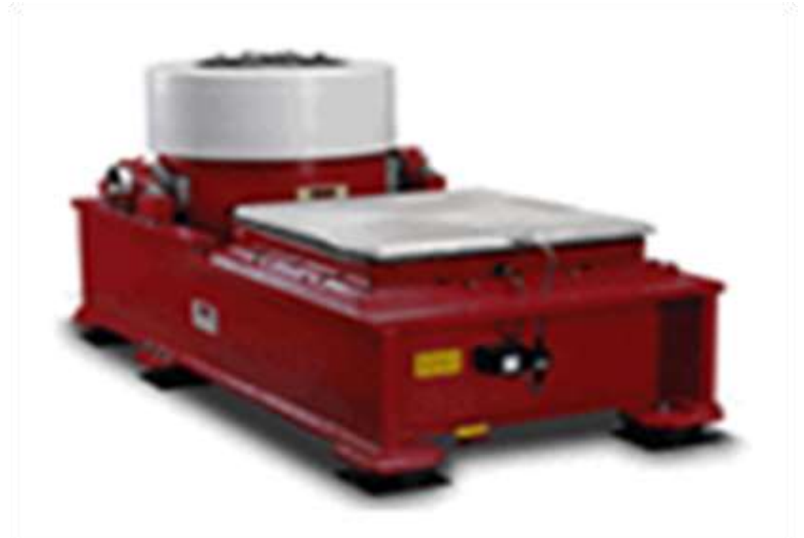
Вибростенд для испытаний приборов БРТК
