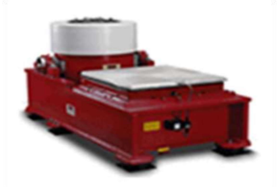
Вибростенд для испытаний приборов БРТК
