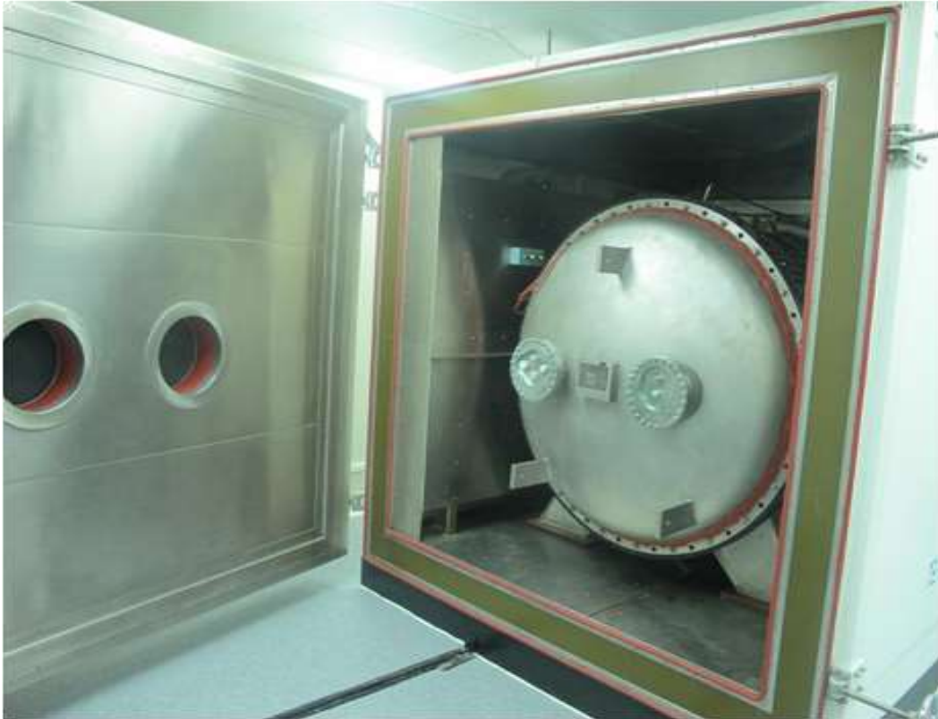
Термовакuumная камера, установленная в чистом помещении
