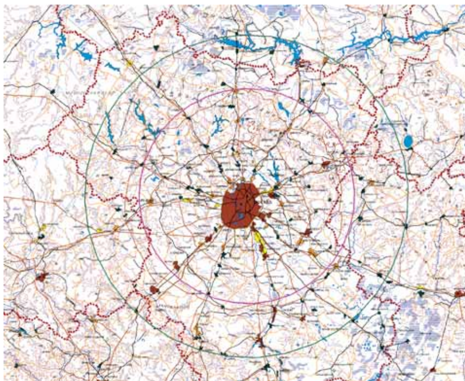
— зона обслуживания аналогового передатчика 11 ТВК (40 кВт) — зона обслуживания цифрового передатчика 33 ТВК (5 кВт)
